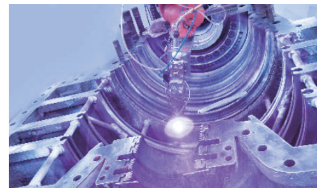
汽轮机缸体现场激光修复
